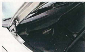
Le numéro de série frappé sur le châssis est sur la traverse à la base du pare-brise
