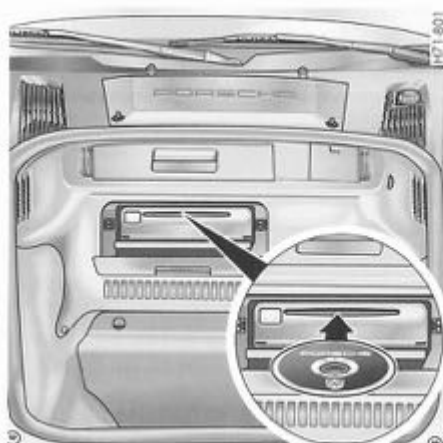
Fig. 9.a. Calculateur de navigation dans le coffre derrière le volet d'accès
