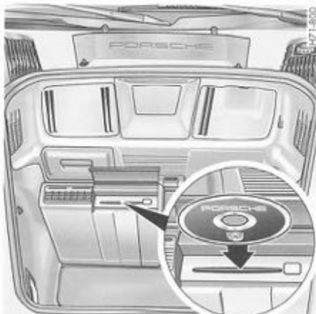
Fig. 10.b. Calculateur de navigation au niveau du tablier du coffre
