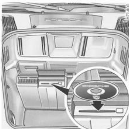
Fig. 9.b. Calculateur de navigation au niveau du tablier du coffre
