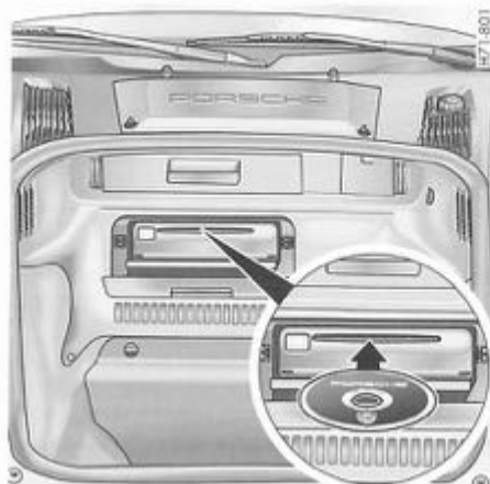
Fig. 10.a. Calculateur de navigation dans le coffre derrière le volet d'accès
