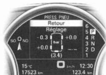
La roue de secours ne comporte pas d'émetteur et n'est pas surveillée par le système de contrôle de la pression des pneumatiques. Une fois que vous avez appuyé sur la touche ENTER, le voyant de contrôle de la pression des pneus s'allume dans le compteur de vitesse. Le sous-menu PRESSION PNEU (informations de gonflage) affiche la valeur « \_ \_ » pour indiquer la position de la roue de secours.
