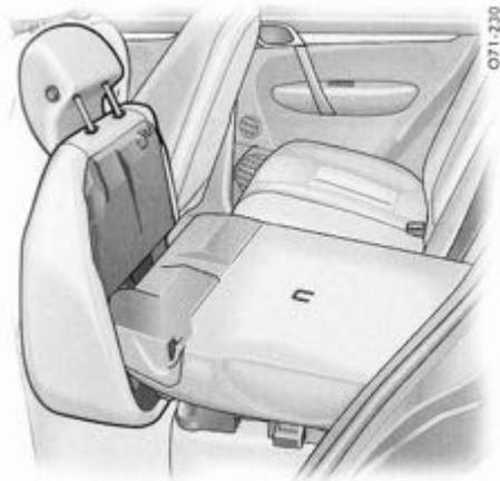
7. Enfoncez l'appui-tête dans le logement du coussin du siège.
