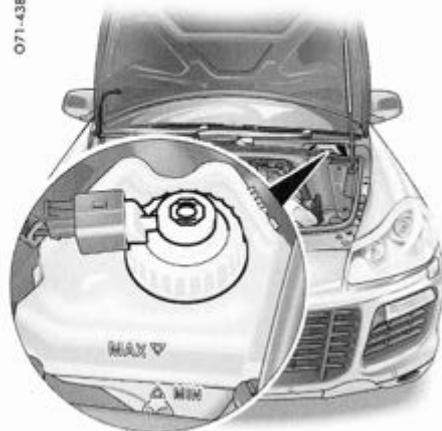
Une petite baisse du niveau, due à l'usure et au rattrapage automatique des freins à disque, est normale.
