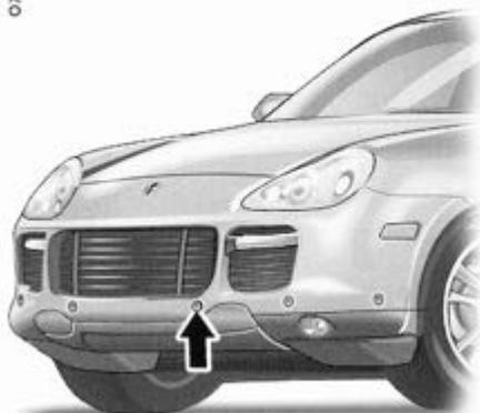
Capteurs à ultrasons avant
