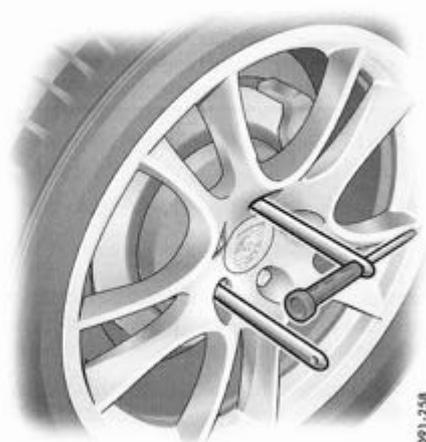
Vissage de **deux** auxiliaires de montage sur les véhicules **avec** PCCB
