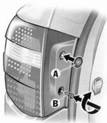
3. Serrez les vis de fixation **B**.
