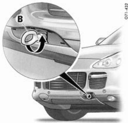
2. Vissez l'œillet de remorquage **B** jusqu'à la butée (filetage gauche) et serrez-le à la main.
