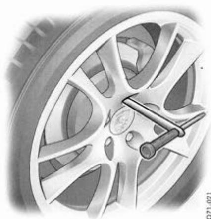
Vissage d'un **auxiliaire** de montage sur les véhicules **sans** PCCB
