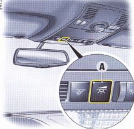
A - Variateur de luminosité pour l'éclairage de confort
