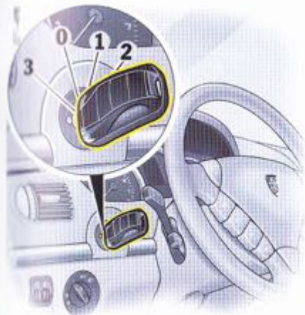
Positions de la clé 0 - Position de base 1 - Contact mis 2 - Démarrage du moteur 3 - Contact coupé
