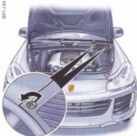
Cache de la boîte à fusibles dans le compartiment moteur
