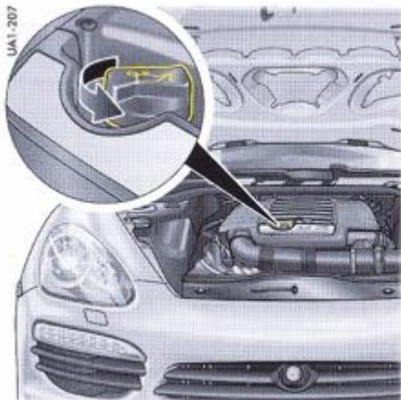
Bouchon de remplissage d'huile moteur V6
