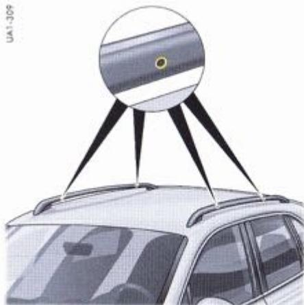
1. Fixez les barres de toit uniquement dans les zones identifiées par un repère. Un orifice est situé sur chacune des parties intérieures des rampes de pavillon. L'axe situé dans le pied d'appui doit s'engager dans cet orifice.
