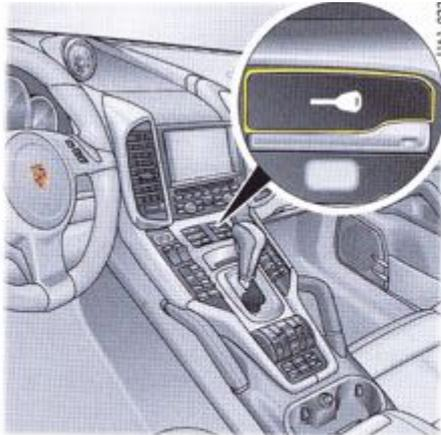
Bouton de verrouillage centralisé avant
