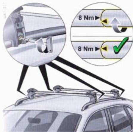
5. Serrez ensuite l'une après l'autre les vis de fixation dans tous les pieds d'appui à l'aide de la clé dynamométrique à 8 Nm. Les deux flèches situées sur la clé dynamométrique doivent pour cela correspondre parfaitement (8 Nm). Les deux barres de toit sont ainsi immobilisées dans le sens longitudinal et transversal.
