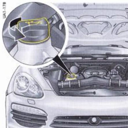
Bouchon de remplissage d'huile moteur V8
