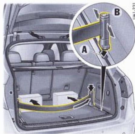
3. Placez les deux éléments d'extrémité de l'enrouleur de sangle dans les orifices **A** des rails de fixation.
