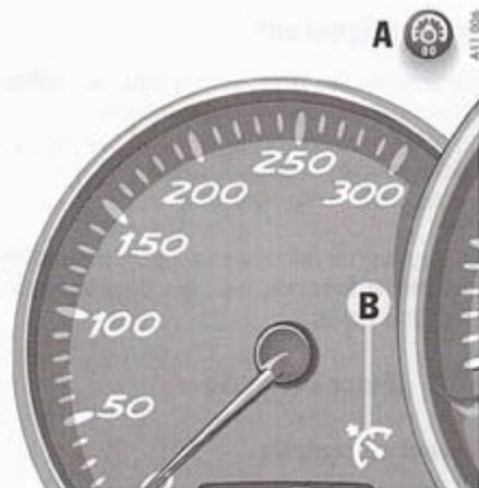
A - Bouton de réglage de l'éclairage des instruments
