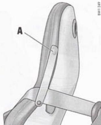
Pour permettre de saisir la ceinture de sécurité plus facilement au moment de boucler celle-ci, la fixer au dossier du siège à l'aide du bandeau de maintien.
