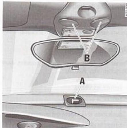
**A** - Diode lumineuse pour système d'alarme
