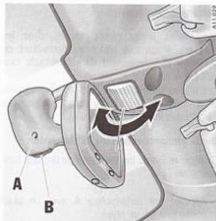
A - Interrupteur pour éclairage de sécurité
