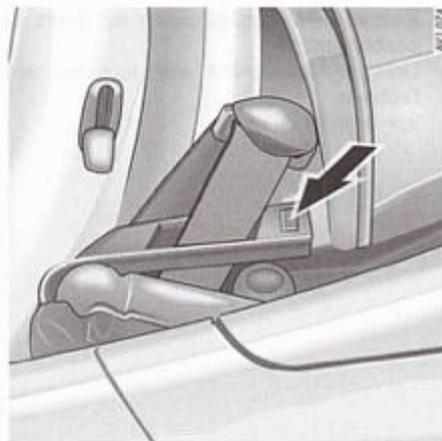
10. Pivotez le levier de verrouillage de la fermeture avant vers l'arrière (cf. flèche **A**). Le crochet de verrouillage doit alors s'accrocher au cadre de pare-brise (cf. flèche **B**). Le trait de repérage blanc figurant sur le bouton de sécurité rouge (cf. flèche **C**) doit être visible si le verrouillage est correct.
