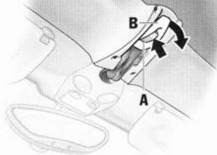
6. Appuyez sur le bouton de sécurité rouge du levier de verrouillage avant (flèche **A**). Ouvrez entièrement la fermeture (flèche **B**).
