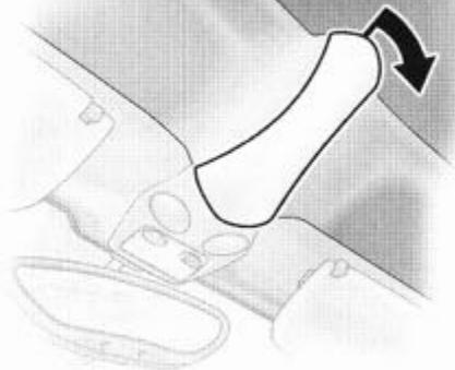
5. Retirez le cache du levier de verrouillage avant (flèche).
