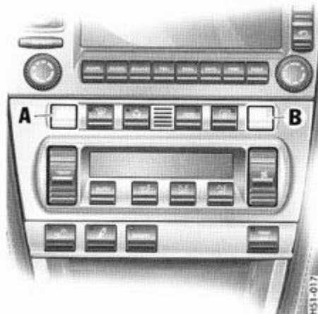
A - Chauffage du siège gauche
