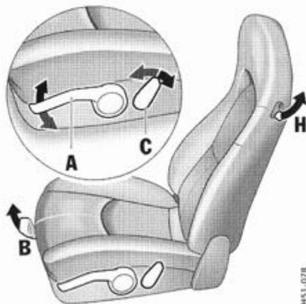
2. Posez le bras tendu sur le volant. Réglez l'inclinaison du dossier et la position du volant de façon à ce que votre poignet repose sur la couronne du volant. Les épaules doivent continuer de bien s'appuyer au dossier.
