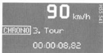
Le nouveau tour de piste s'affiche sur l'ordinateur de bord et dans le PCM. Le temps dans l'ordinateur de bord et le PCM commence à zéro. Le chronomètre du tableau de bord continue à afficher le temps total.
