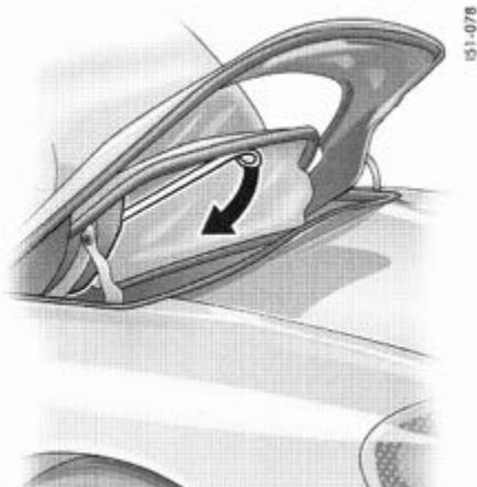
6. Décrochez la fermeture Velcro de la sangle de maintien.
