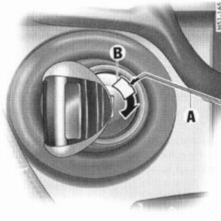
3. A l'aide du crochet métallique **A**, retirez le couvercle en plastique **B** du contacteur d'allumage/démarrage. Attention de ne pas perdre le couvercle en plastique **B**.
