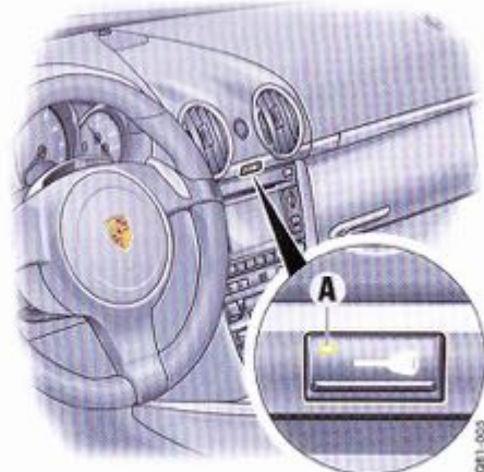
A - Diode lumineuse du système d'alarme
