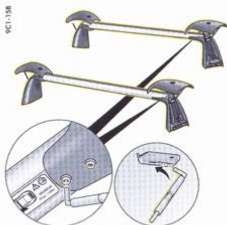
Retirez les supports et resserrez bien les vis sur le dessous des supports avec l'extrémité courte de la clé dynamométrique.
