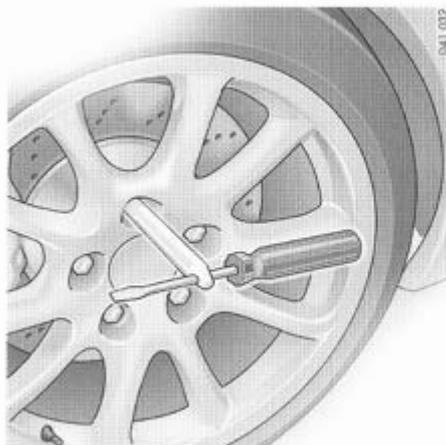
Vissez l'auxiliaire de montage sur les véhicules **non équipés** de disques de frein en céramique PCCB
