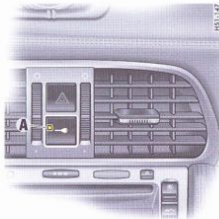
A - Diode lumineuse du système d'alarme
