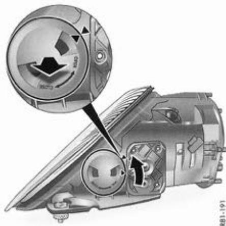
**Remplacement de l'ampoule de feu auxiliaire
