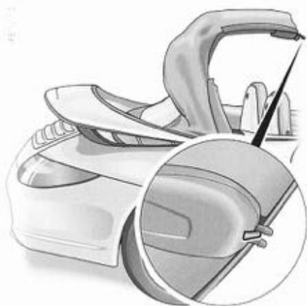
Le système de verrouillage est fixé avec le crochet de verrouillage à la capote. Effectuez les travaux au niveau du verrouillage de capote depuis le côté droit du véhicule.
