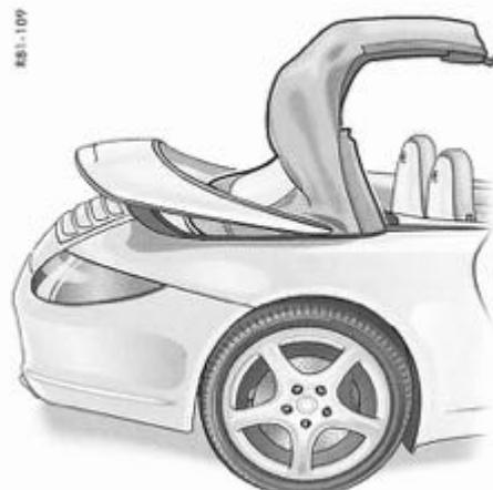
3. Tirez sur la capote en direction de la fermeture jusqu'à atteindre la position la plus haute.
