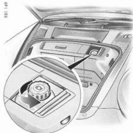
Une petite baisse du niveau, due à l'usure et au rattrapage automatique des freins à disque, est normale.
