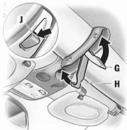
11. Pivotez le levier de verrouillage avant **G** vers l'arrière.
