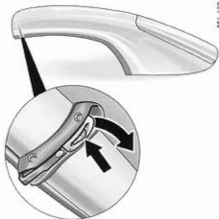
6. Appuyez sur le bouton de sécurité rouge du levier de verrouillage avant. Ouvrez intégralement le levier de verrouillage.
