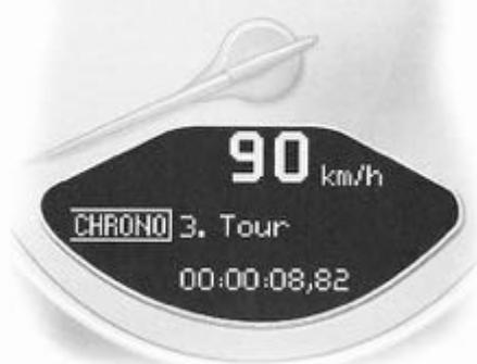
Le nouveau tour de piste s'affiche sur l'ordinateur de bord et dans le PCM. Les temps dans l'ordinateur de bord et le PCM commencent à zéro. Le chronomètre du tableau de bord continue à afficher le temps total.
