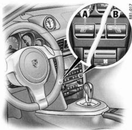
**A** - Chauffage du siège gauche
