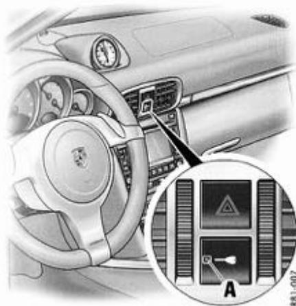
A Diode lumineuse du système d'alarme
