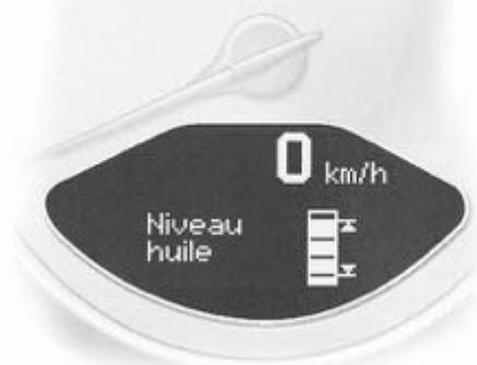
6. Des segments remplis jusqu'à la ligne supérieure signifient que le niveau d'huile a atteint le repère maximum. Ne rajoutez en aucun cas de l'huile moteur.
