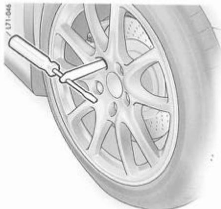
Auxiliaire de montage sur les véhicules **sans** PCCB
