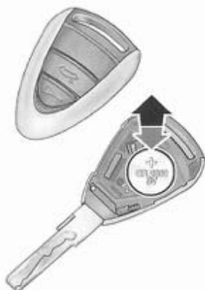
3. Remplacez le cache et pressez ensemble les deux pièces. Veillez à respecter les prescriptions relatives à l'élimination des piles et batteries.
