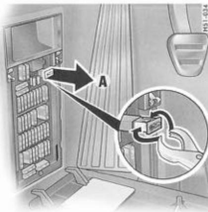
4. À l'aide d'un câble auxiliaire de démarrage, reliez le pôle plus de la batterie extérieure au pôle plus **A** de la boîte à fusibles.
