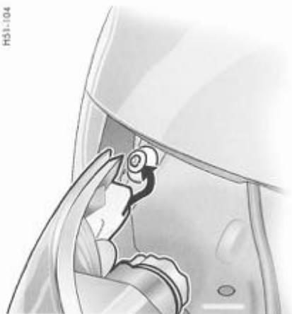
7. Placez le feu arrière dans la partie latérale. Vérifiez que l'ergot de maintien s'insère correctement dans le guide de la partie latérale.
