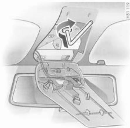
5. Enfoncez la clé Allen dans l'axe d'entraînement, maintenez-la enfoncée et tournez-la vers la droite jusqu'à ce que le toit ouvrant se ferme.
