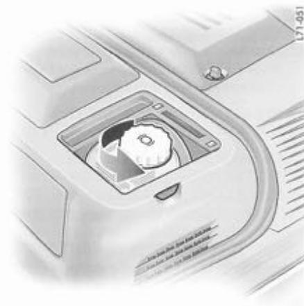
normale. Si le niveau du liquide baisse sensiblement ou descend en deçà du repère Min., le circuit de freinage peut être devenu perméable.
