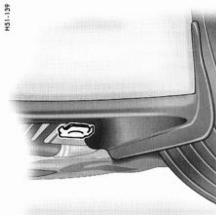
Logement du cric pour changer une roue à l'arrière
