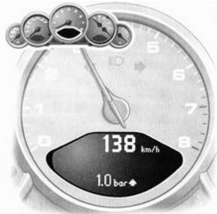
Une flèche apparaît à côté de l'affichage de la pression de suralimentation. La fonction Overboost est efficace pendant env. 10 secondes et, une fois ce temps écoulé, elle peut être réactivée si vous appuyez rapidement sur la pédale d'accélérateur.
