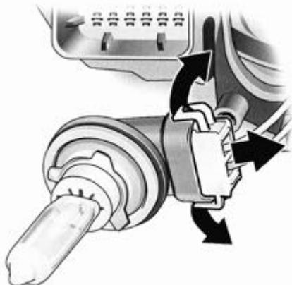
2. Écartez les deux languettes de déverrouillage du connecteur.
