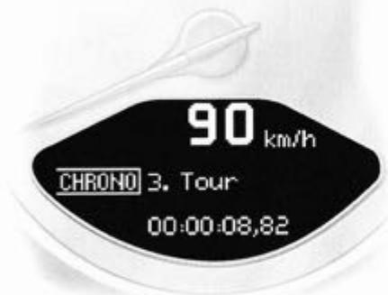
Le nouveau tour de piste s'affiche sur l'ordinateur de bord et dans le PCM. Les temps dans l'ordinateur de bord et le PCM commencent à zéro. Le chronomètre du tableau de bord continue à afficher le temps total.
