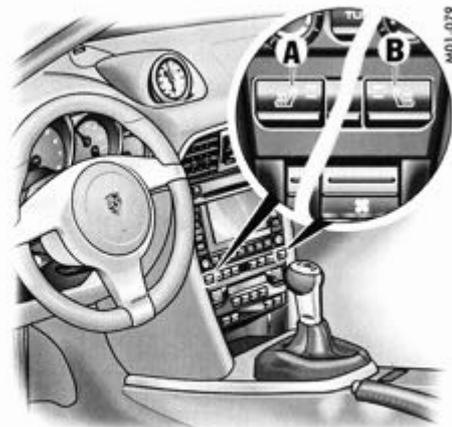
A - Chauffage du siège gauche
