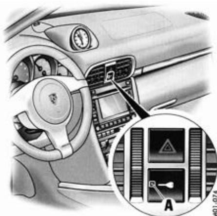
A - Diode électroluminescente du système d'alarme
