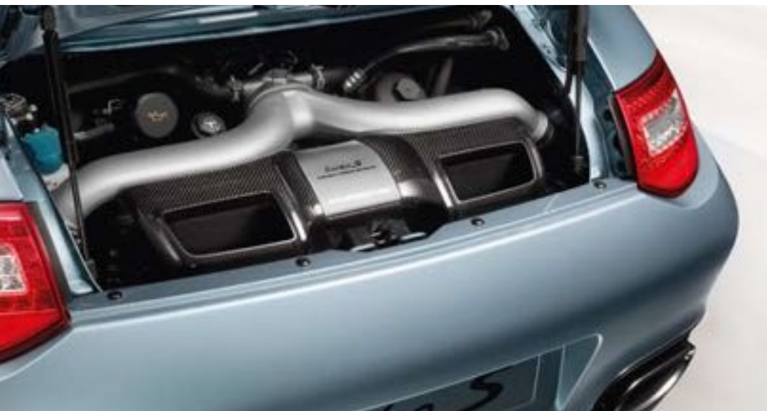
Moteur avec boîtier de filtre à air en carbone des nouveaux modèles 911 Turbo S
