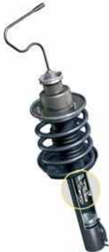
Phase de détente – Piston moteur et by-pass = réglage sportif-confortable
