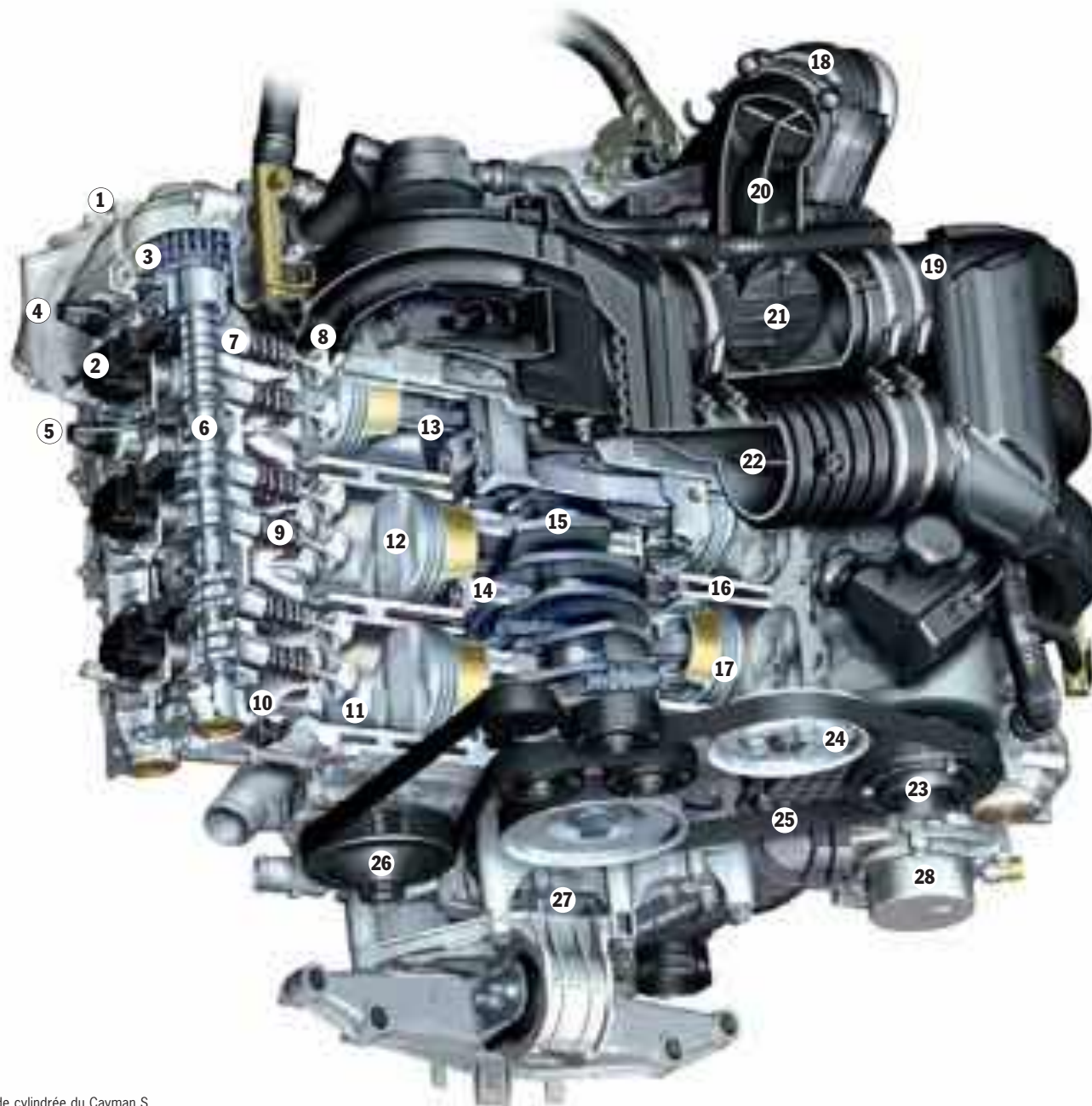
Moteur 6 cylindres à plat de 3,4 litres de cylindrée du Cayman S
