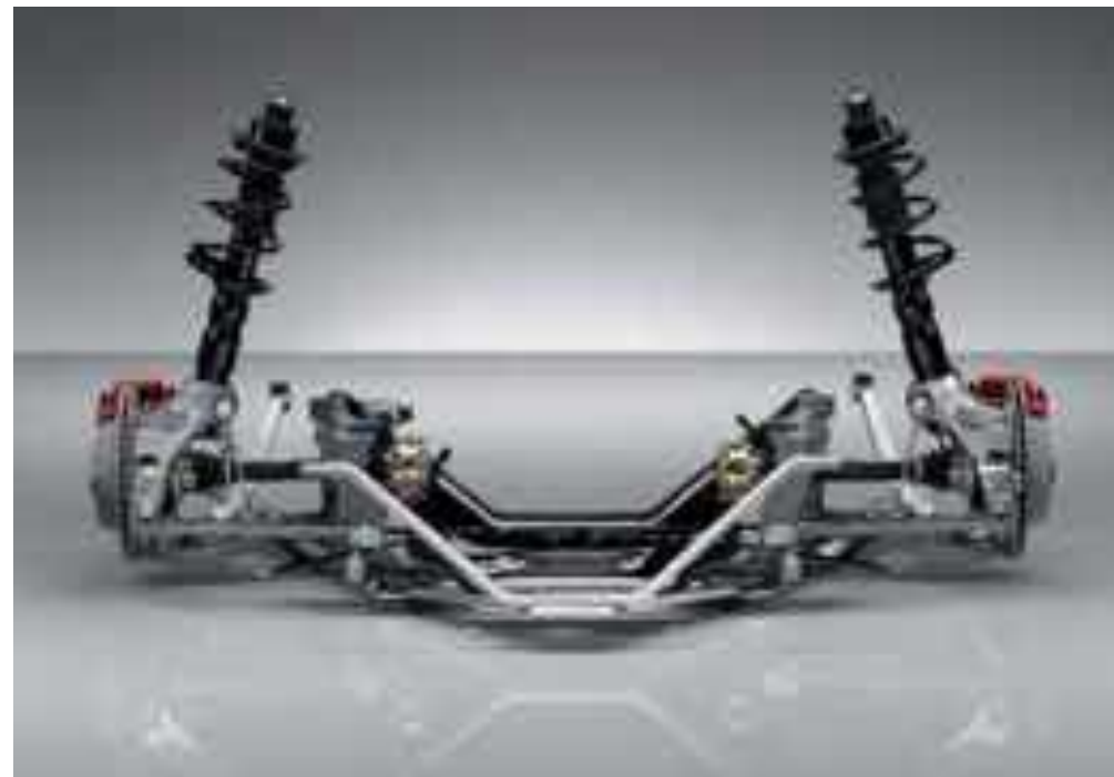
Essieu arrière McPherson avec bras triangulaires et jambes de force du Cayman S
