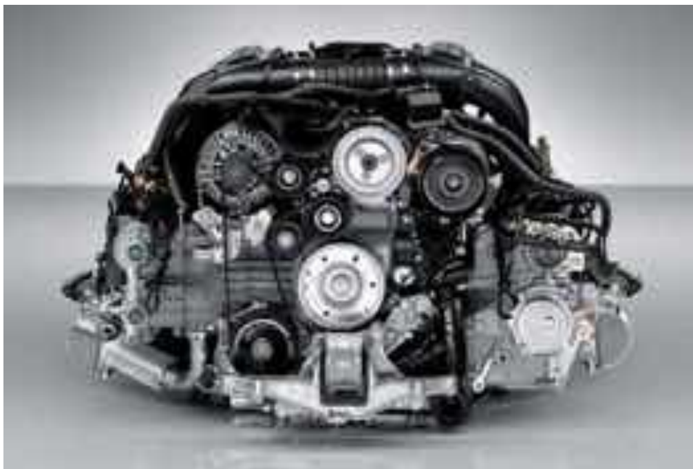
Moteur 6 cylindres à plat de 3,4 litres de cylindrée du Cayman S
