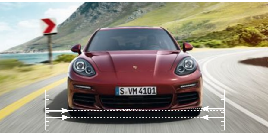
Passage rapide en virage sans PDCC (schéma de principe)
