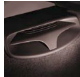
Enceinte 10,2 x 15,3 cm pour les graves logée dans un caisson de basses de 6 l
