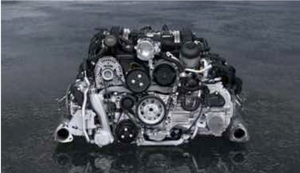
Moteur 6 cylindres à plat 3,8 l
