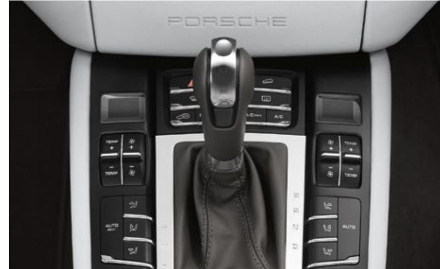
Boutons de commandes avant pour climatisation automatique 2 et 3 zones
