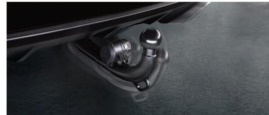
Dispositif d'attelage électrique rétractable
