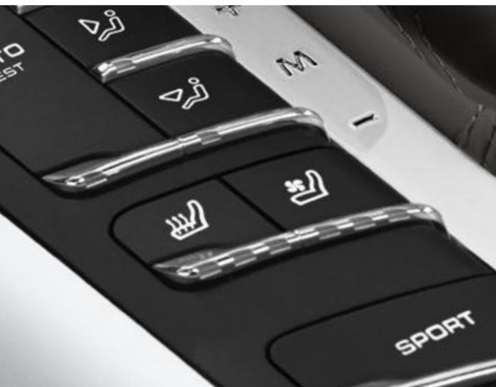
Commande de siège chauffant/siège ventilé
