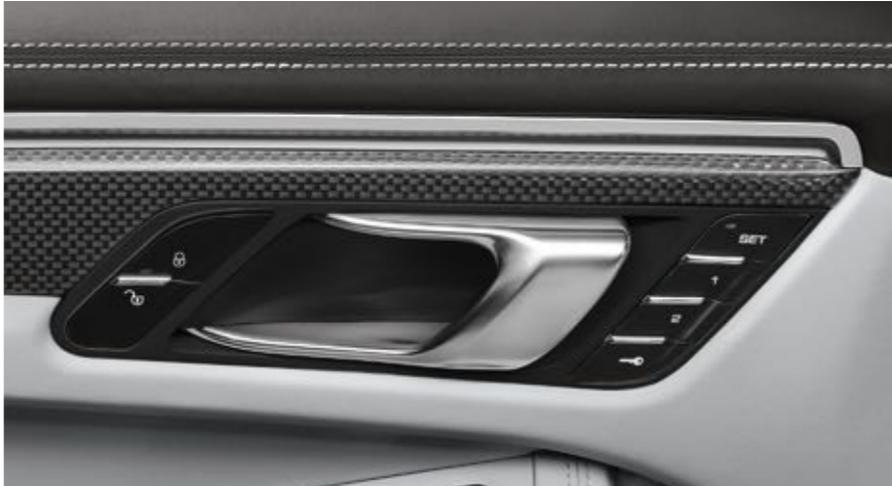
Commandes du Pack Mémoire Conducteur et verrouillage centralisé
