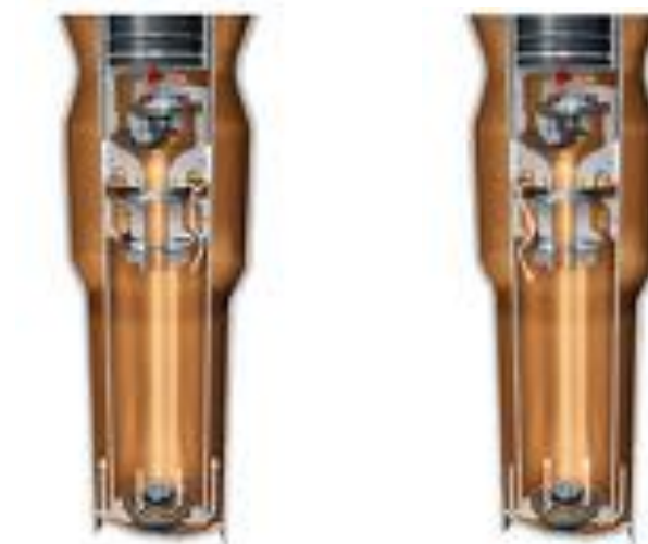
Phase de compression – Piston plus by-pass = réglage sportif plus ferme
