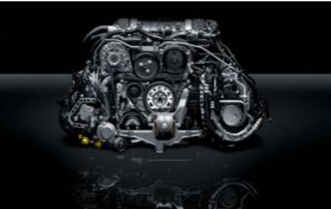
Moteur 6 cylindres à plat de 3,4 litres du Cayman S
