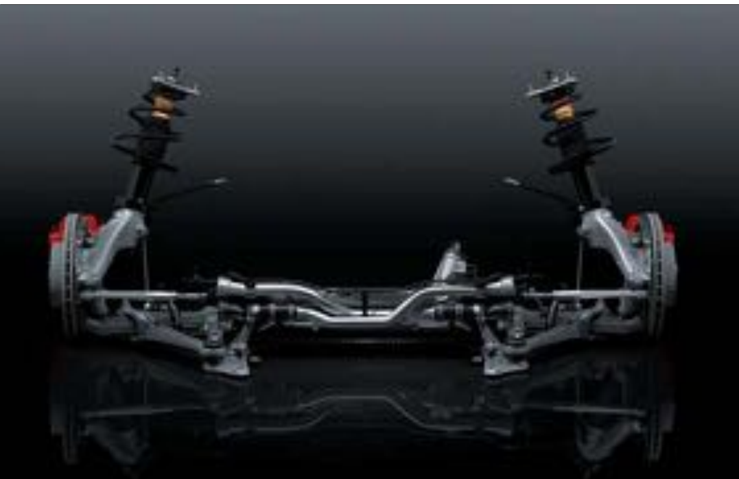
Essieu avant du Cayman S de conception allégée avec bras de suspension et jambes de force
