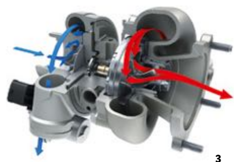
1 Ailettes orientables fermées | 2 Ailettes orientables ouvertes | 3 Turbine à géométrie variable
