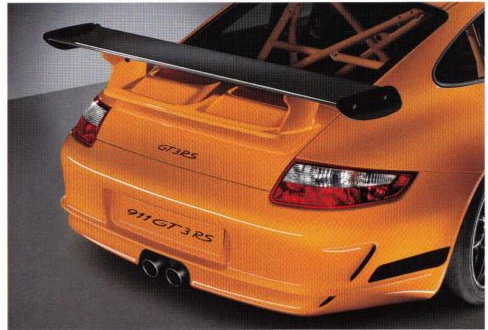
Emprunté à la 911 GT3 Cup, l'aile de la nouvelle 911 GT3 RS est en fibres de carbone, donc plus léger que celui de la 911 GT3. Il est également surdimensionné pour maximiser l'appui aérodynamique sur l'essieu arrière. Inclinaison comme celui de la 911 GT3, il optimise la stabilité, même à vitesses élevées.
