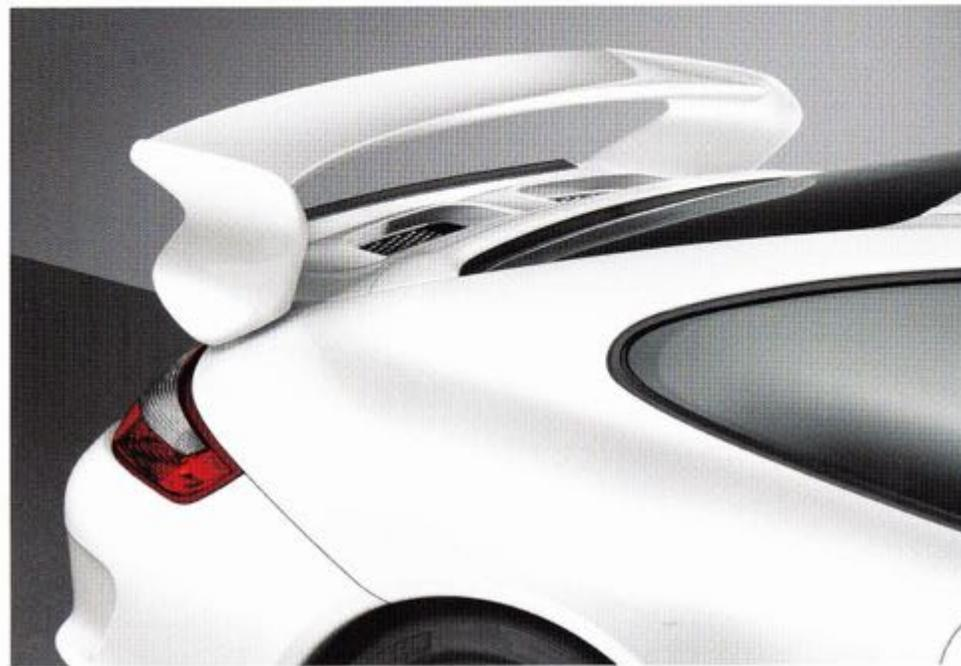
La poupe est dominée par un double aileron fixe. Pour une utilisation sur circuit, l'aileron supérieur possède un profil à inclinaison variable. Le double aileron assure au véhicule une stabilité dynamique optimale à vitesse élevée. Autre détail important : la lèvre en caoutchouc (dite Gurney Flap) sur l'aile inférieure qui fait office d'aileron.
