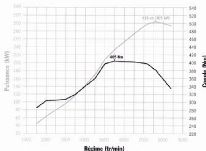
911 GT3 RS/911 GT3 : 405 Nm à 5 500 tr/min, 415 ch (305 kW) à 7 600 tr/min
