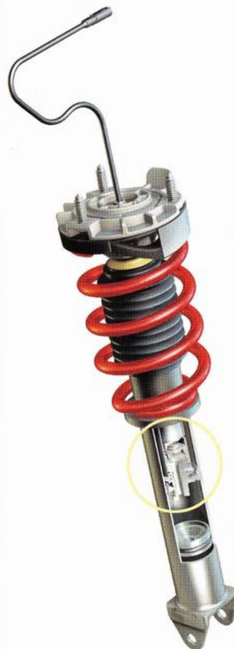
Phase de détente - Piston et bypass
