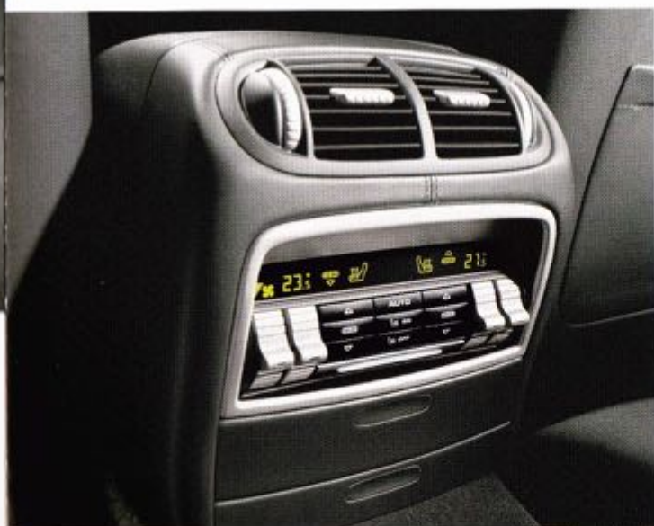
Climatisation à l'arrière
