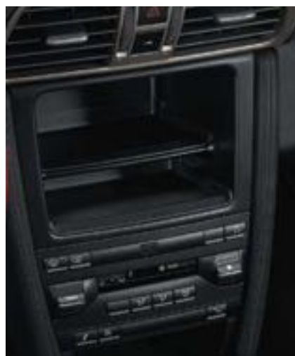
Suppression de la climatisation, suppression du système audio
