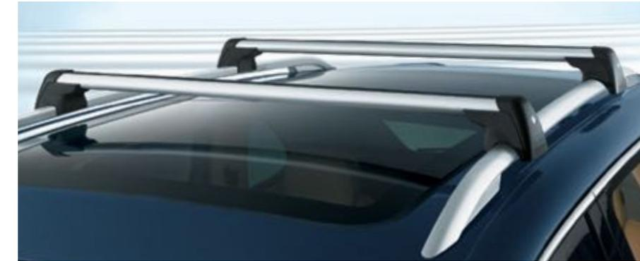
Rampes de pavillon en AluDesign mat avec système de transport sur toit
