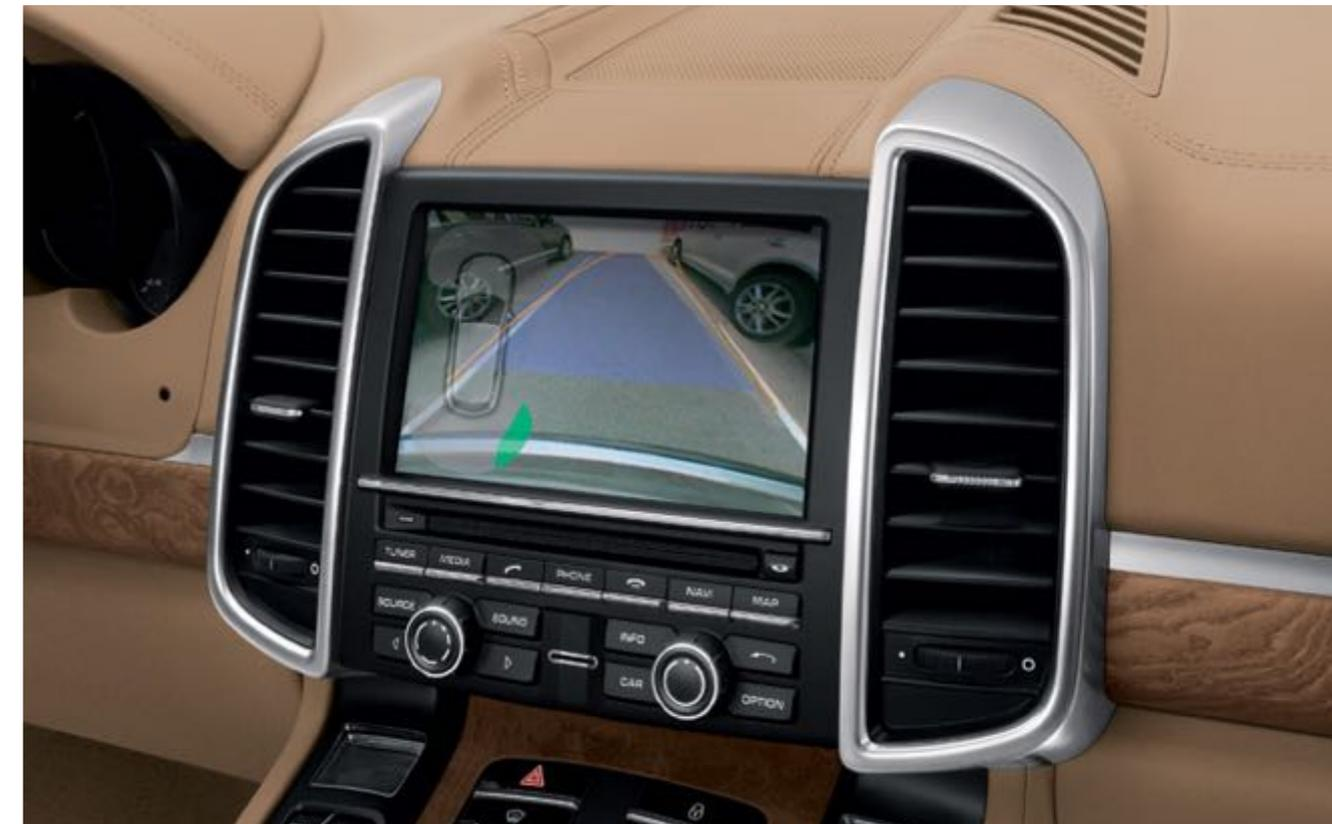
Image restituée par la caméra de recul, sur le PCM
