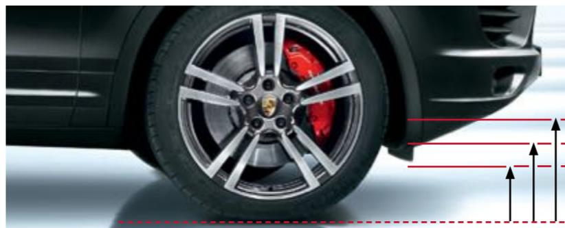
Les différents niveaux de la suspension pneumatique
