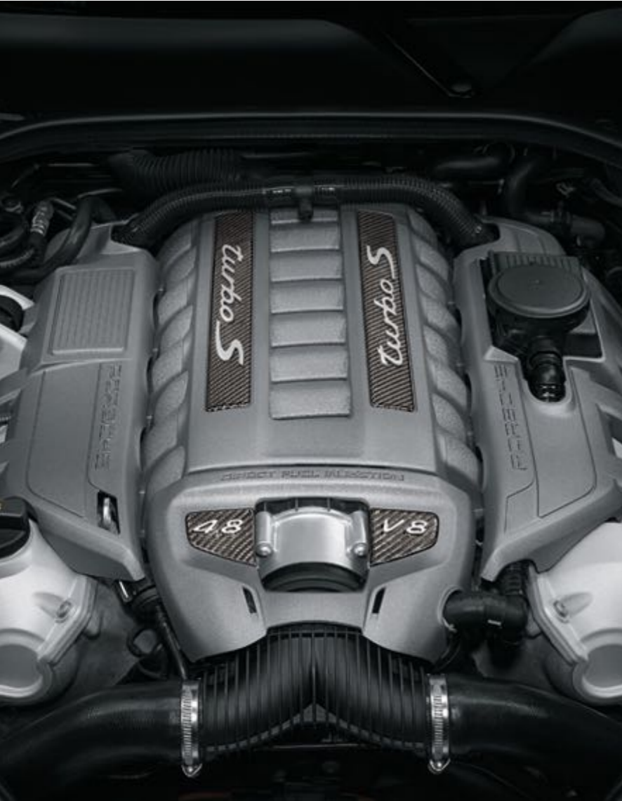
Moteur V8 biturbo de 4,8 litres
