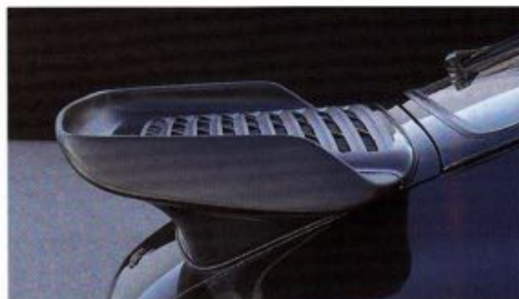
Arrière caractéristique de la Turbo. Le refroidisseur d'air de suralimentation est intégré au becquet
