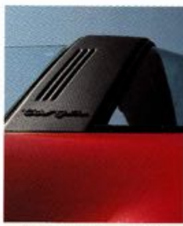
L'arceau typique de la Targa joue le rôle d'un arceau de sécurité
