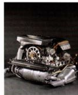
Moteur boxer turbo: conception classique, technologie de pointe
