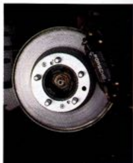
Pour une efficacité maximum: des disques ventilés à l'arrière
