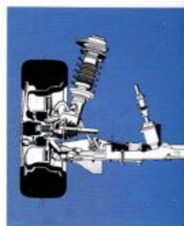
Roues avant guidées par jambes de force et bras triangulés
