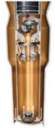
Phase de détente – Piston seul = réglage sportif ferme
