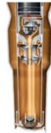
Phase de compression – Piston et bypass = réglage sportif confortable
