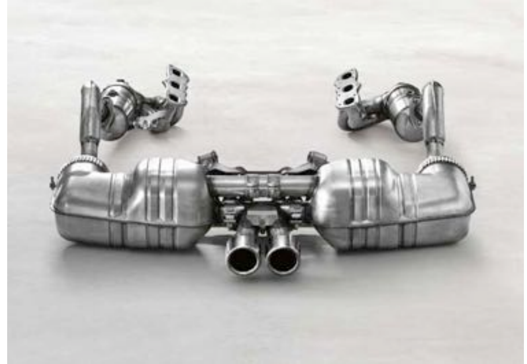
Système d'échappement du Boxster S
