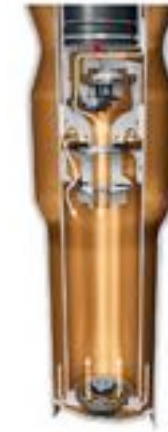
Phase de détente – Piston et bypass = réglage sportif confortable
