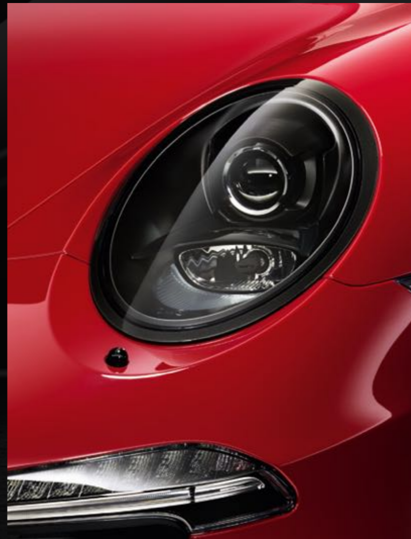
Phare Bi-Xénon avec fonction PDLS (équipement de série)
