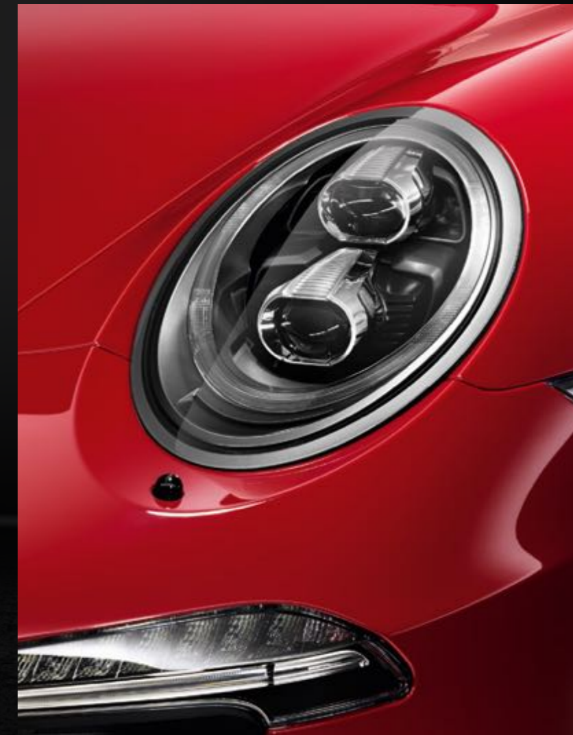
Phares à DEL avec fonction PDLS+
