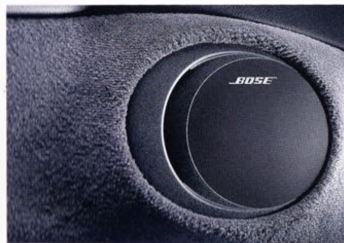
Module bass-reflex pour les fréquences moyennes et aigües dans la portière
