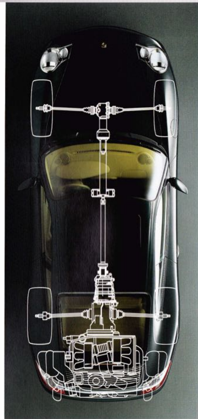
Transmission intégrale avec viscocoupleur à lamelles et PSM
