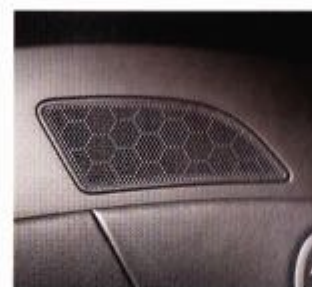
Enceinte Néodyme 2,5 cm pour les fréquences aigües
