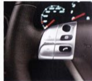
Palettes Tiptronic S sur le volant
