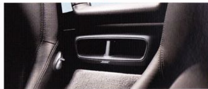
Subwoofer actif avec respectivement 2 HP 13,0 cm pour les graves et 2 HP 6,5 cm médium-aigües
