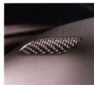
Microphone pour AudioPilot™ intégré dans la colonne de direction
