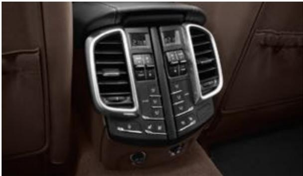
Commandes de chauffage et de ventilation des sièges avant et arrière
