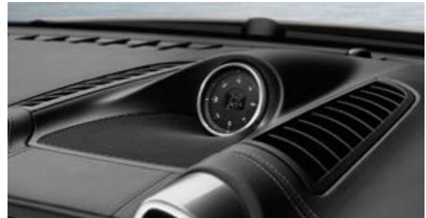
Module boussole sur la planche de bord
