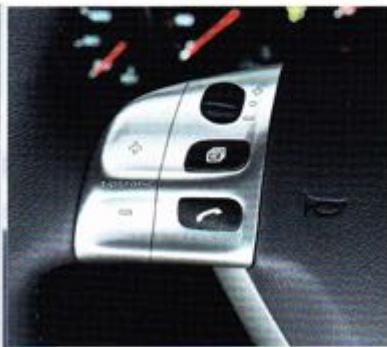
Basculeur Tiptronic S sur le volant
