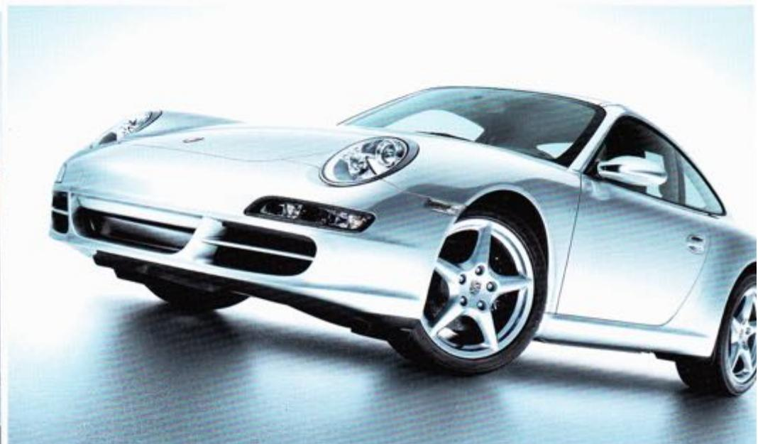
Elle n'a pas pris un gramme. Que de la puissance à l'état pur. Une règle fondamentale pour gagner en compétition, qui s'applique aussi à la 911. Son moteur 6 cylindres à plat de 3,6 l de cylindrée, caractérisé par les deux sorties d'échappement simples, développe 325 ch (239 kW) à 6 800 tr/min.
