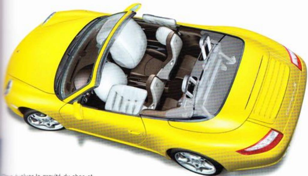
Pour évaluer la gravité du choc et le temps de collision, deux capteurs supplémentaires intégrés au niveau des phares viennent compléter l'unité centrale sur le tunnel central. Le risque de collision est détecté et évalué à temps.
