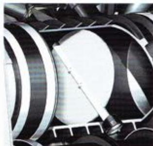
Clapet de réglage dans le système d'admission
