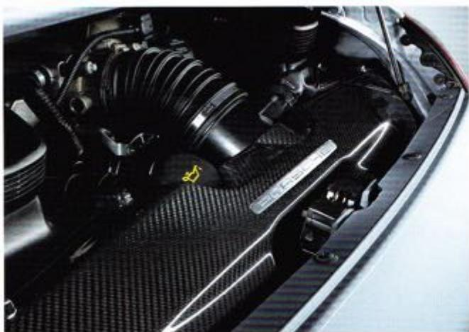
Boîtier de filtre à air en carbone
