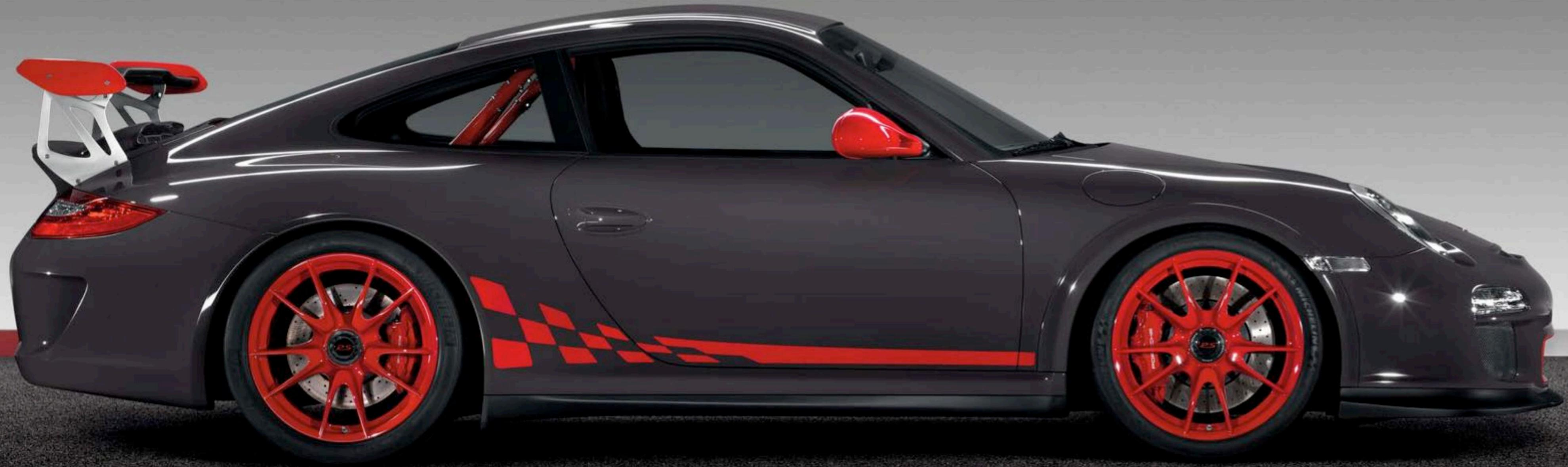
Le capot arrière arbore la signature GT3 RS. Légère, la lunette arrière est en matière plastique technique. Typique : l'imposante sortie d'air supplémentaire (Ram Air) sur le capot arrière. Pour un guidage de l'air et donc un refroidissement encore optimisés.
