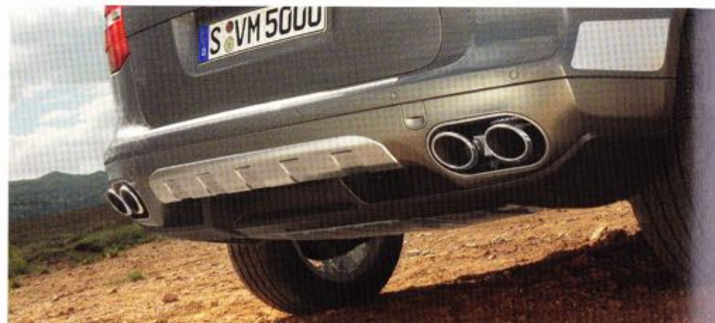
Carter de protection arrière en acier spécial
