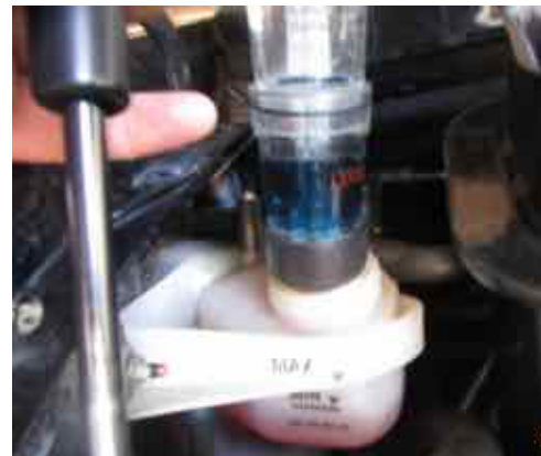
Test de CO2 dans le liquide de refroidissement
