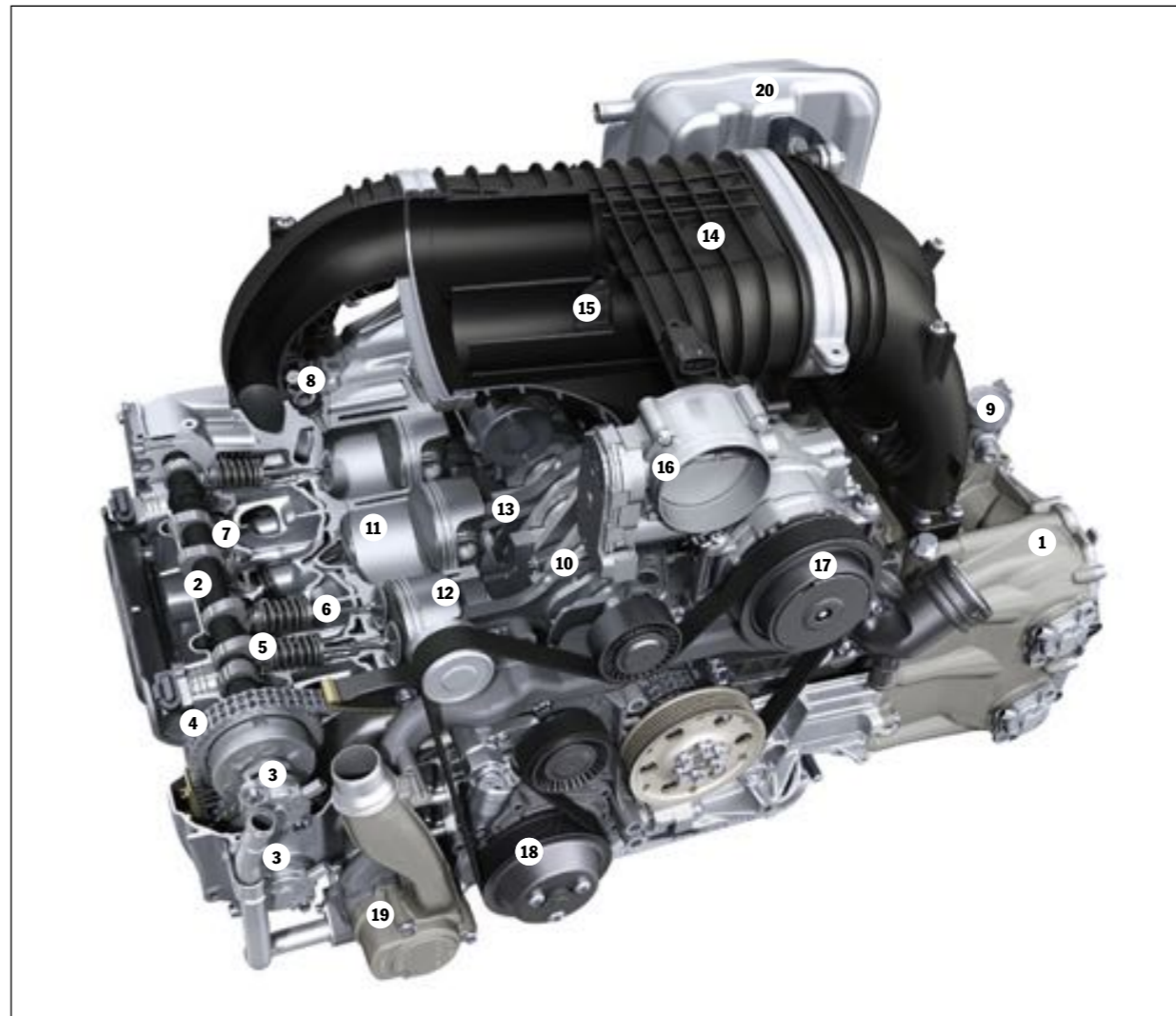
Moteur 6 cylindres à plat, vue en coupe
