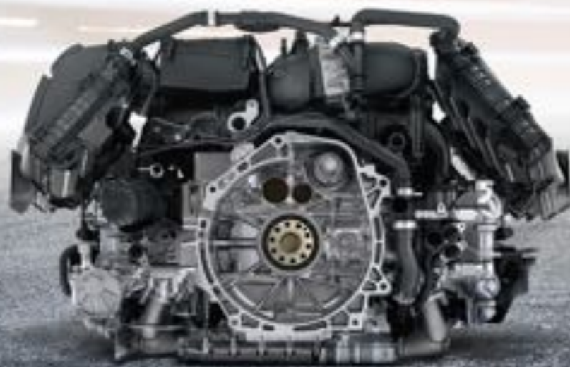
718 Boxster et 718 Cayman : 300 ch (220 kW) à 6 500 tr/min, 380 Nm entre 1 950 et 4 500 tr/min
