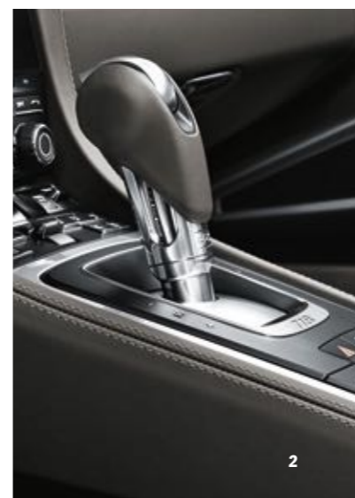
1 Levier de vitesse de la boîte mécanique à 6 rapports 2 Sélecteur de la boîte PDK
