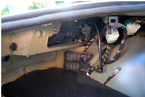
Absence de trace de réparation sur longerons arrières gauche et droit
