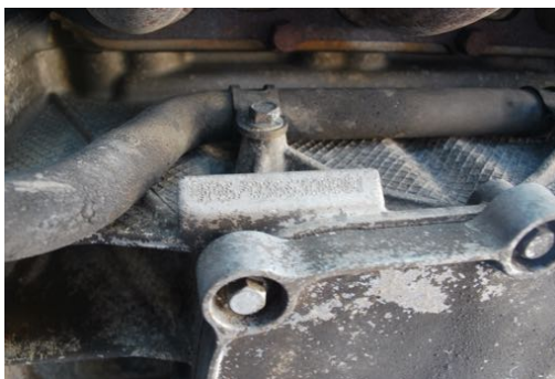
Frappe à froid numéro de moteur
