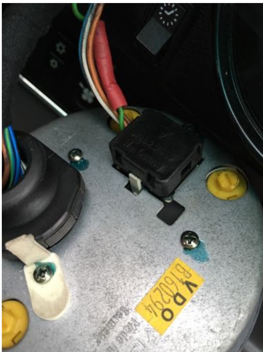
Compteur kilométrique ne présentant pas de trace de démontage / d'ouverture.
