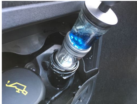
Test de CO2 dans le liquide de refroidissement
