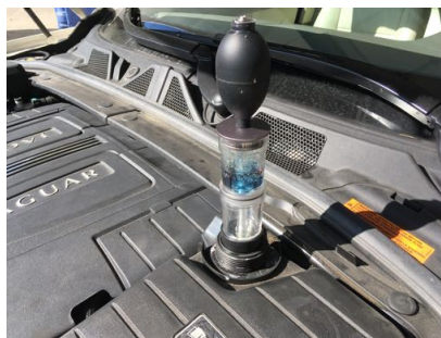
Présence de CO2 dans le liquide de refroidissement
