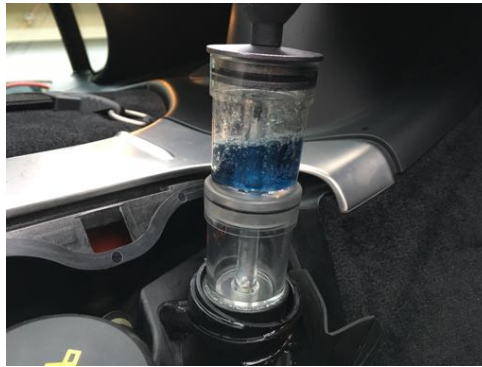
Test CO2 dans le liquide de refroidissement
