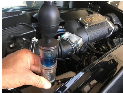
Test CO2 dans le liquide de refroidissement
