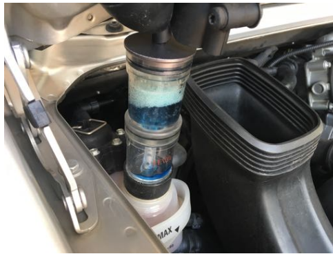
Pas de CO2 dans le liquide de refroidissement
