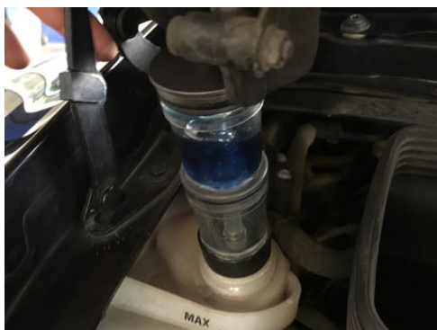
Absence de CO2 dans le liquide de refroidissement
