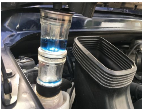
Absence de trace de CO2 dans le liquide de refroidissement
