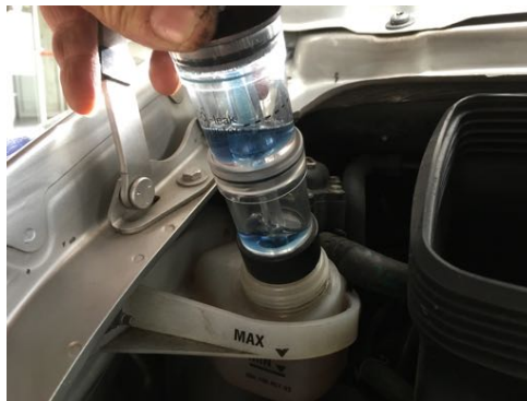
Absence de CO2 dans le liquide de refroidissement
